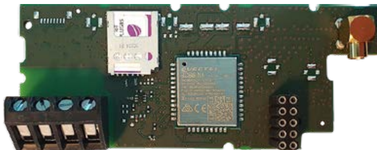
A SIM kártya a modulba integrálva.
