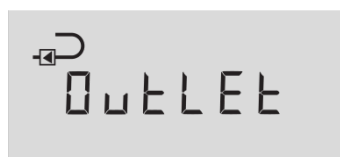
Visning når returløb er valgt. (Display when outlet meter is chosen)
