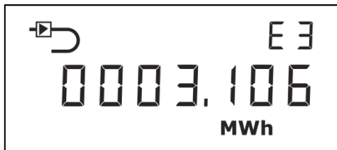
Visning når fremløb er valgt. (Display when inlet meter is chosen).
