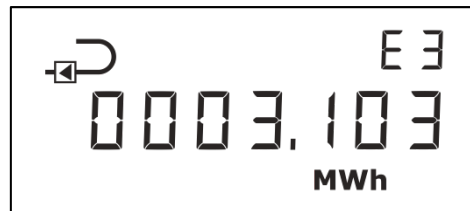
Visning når returløb er valgt. (Display when outlet meter is chosen).
